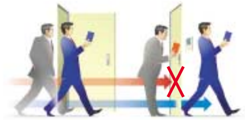
入室側 アンチバスバック機能 退室側
