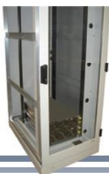
Cool Serve®は、サーバラックへ実装しラック内の熱負荷を効率的に排出する19インチ仕様熱交換器(空気・水)です。サーバの排熱をラック背面から吸入し、高性能熱交換器により冷却した空気を前面から放出し、ラック内の機器を冷却します。
