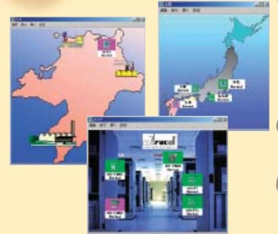
監視マップ上に監視マップアイコンを貼り付けることで、監視マップの階層構造を作成できます。下位層の監視マップで発生した状態変化は、自動的に上位の監視マップアイコンに反映します。
