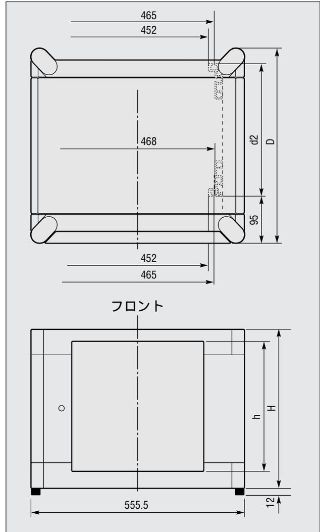
トップ、サイド、ボトム、リヤの各カバーとスチールプレート（一体型鍵付）によるフロントドアによって構成されており、ボトムカバーの両サイドにはベンチレーションが付き、リヤカバーには上部にベンチレーション、下部にケーブル孔が付いています。
