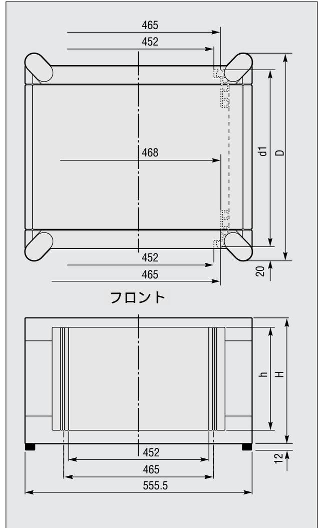
トップ、サイド、ボトム、リヤの各カバーによって構成されておりボトムカバーの両サイドにはベンチレーションが付き、リヤカバーには上部にベンチレーション、下部にケーブル孔が付いています。
