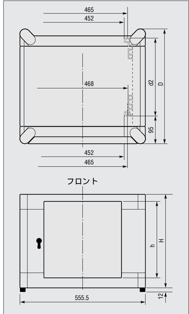
トップ、サイド、ボトム、リヤの各カバーとアクリルプレート（フレーム付）によるフロントドアによって構成されており、ボトムカバーの両サイドにはベンチレーションが付き、リヤカバーには上部にベンチレーション、下部にケーブル孔が付いています。
