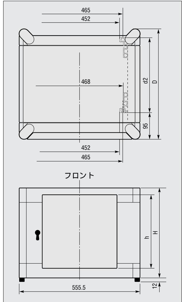
トップ、サイド、ボトム、リヤの各カバーとスチールプレート（フレーム付）によるフロントドアによって構成されており、ボトムカバーの両サイドにはベンチレーションが付き、リヤカバーには上部にベンチレーション、下部にケーブル孔が付いています。
